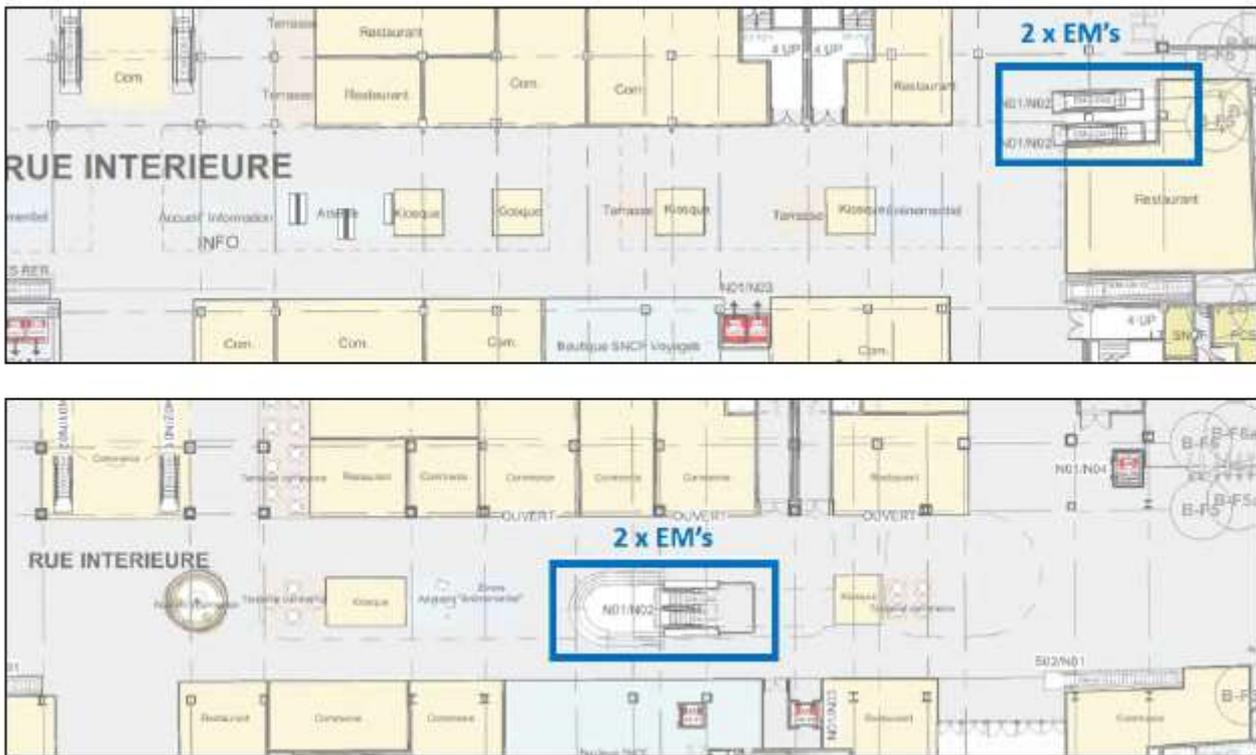
Figure 39 : Plan N01 du DPC (haut) et PCM (bas) avec repérage des escaliers mécaniques (EM's) repositionnés pour être plus facilement repérables et accessibles pour le public
